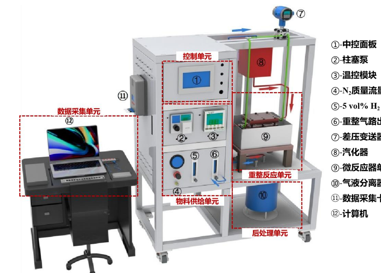
图8 甲醇重整制氢系统实验平台
