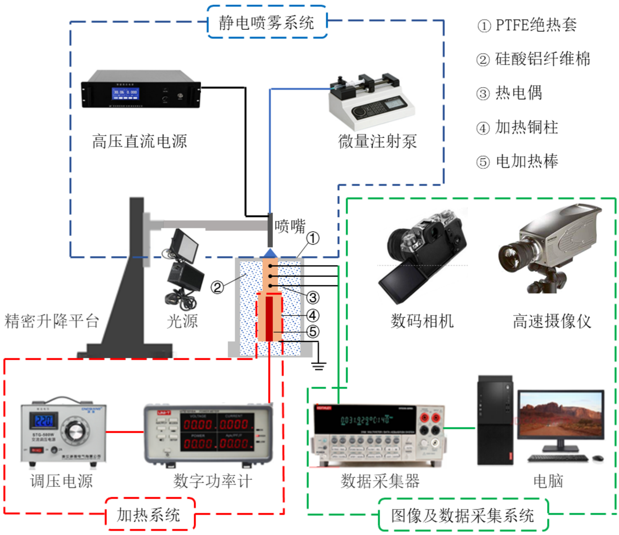
图4 静电喷雾实验系统装置
